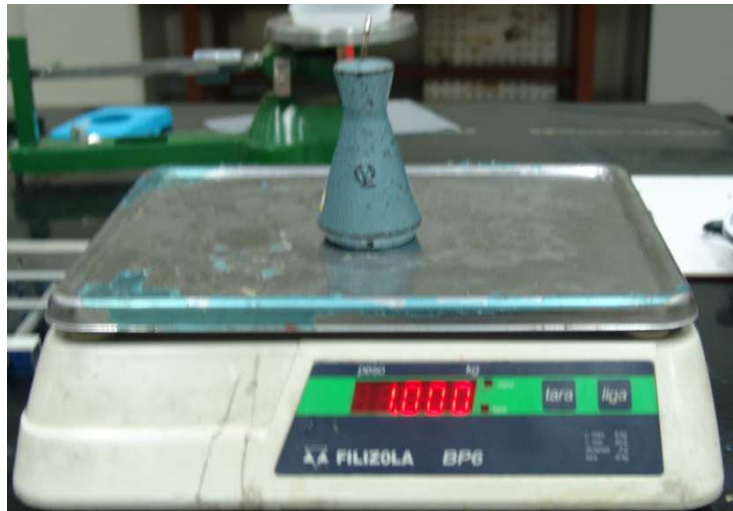
Figura 31 – Foto da verificação do dinamômetro
