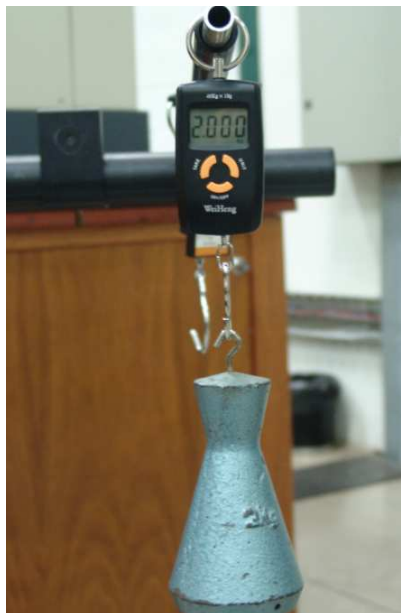
Figura 32 – Foto da verificação do dinamômetro
