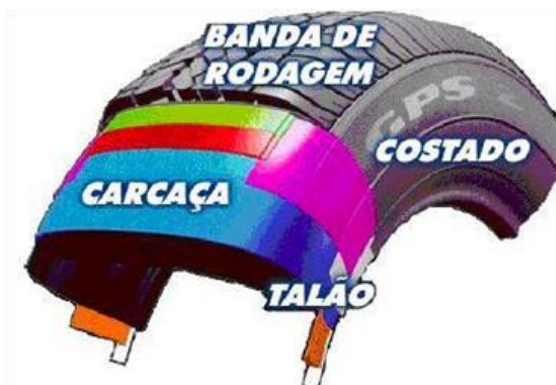
Figura 18 – Composição de um pneu.
