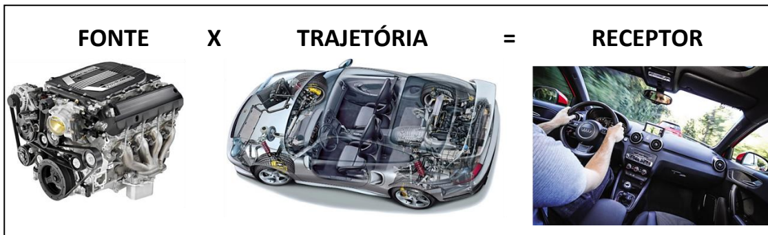
Figura 19 – Esquema do processo de percepção do ruído em veículos.
