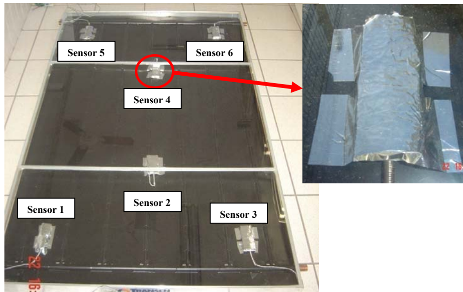
Figura 21: Coletor utilizado no teste experimental mostrando os Termopares instalados na placa.
