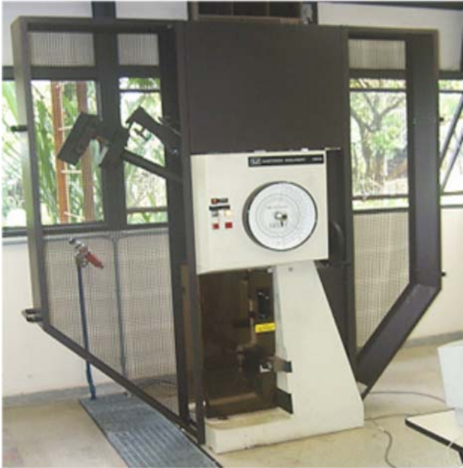
Figura 24: Máquina de ensaios de impacto Charpy INSTRON WOLPERT PW30. do Laboratório de Ensaios Mecânicos do CDTN.
