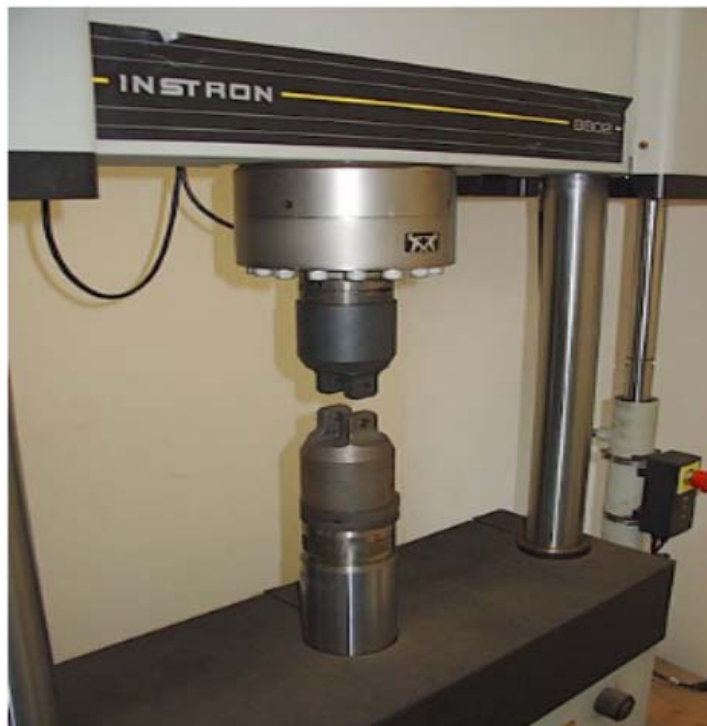
Figura 25: Máquina universal Instron, modelo 8802. Fonte: Laboratório de ensaios mecânicos do CDTN.
