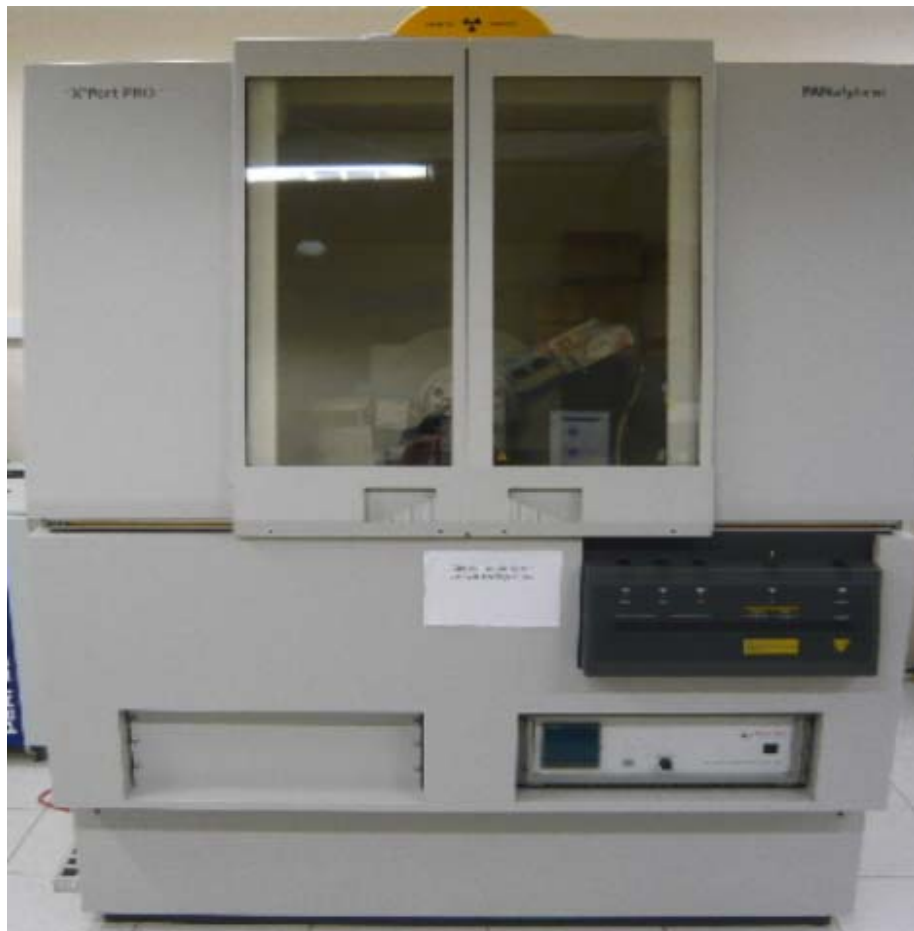
Figura 19: Difratorômetro de raios-X ,Panalytical (X'Pert Pro MPD) da Acellor Mittal, Timóteo.
