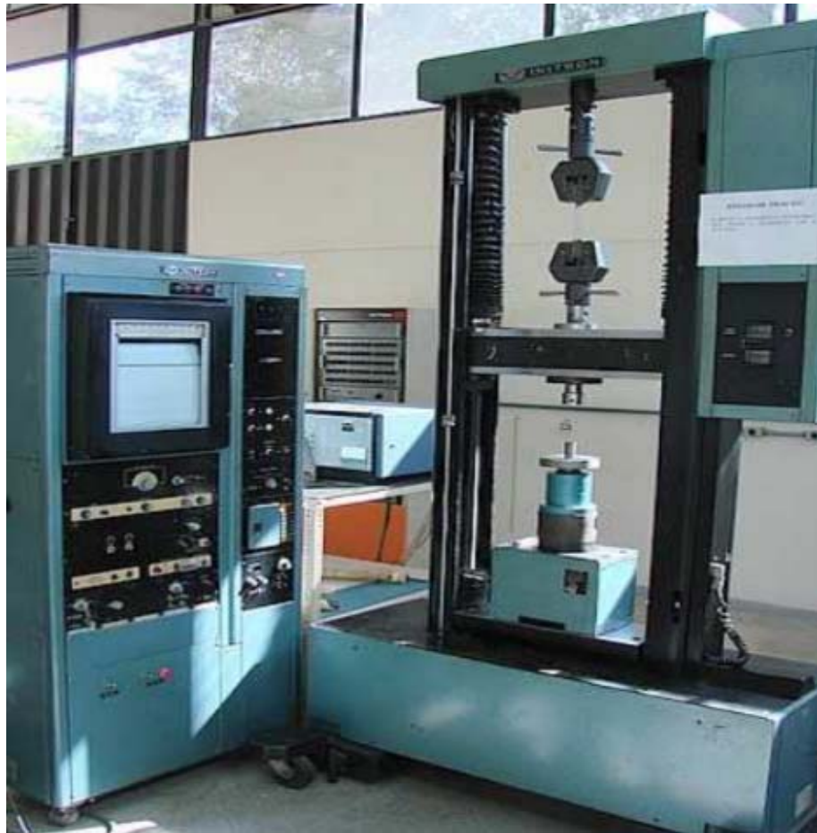
Figura 20: Máquina de ensaio de tração do Laboratório de ensaios mecânicos do CDTN.
