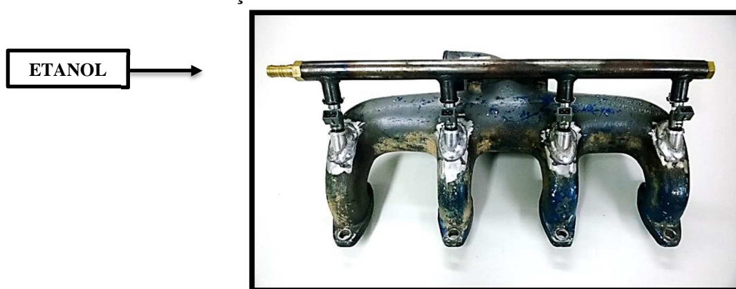
Figura 12 – Ramo de distribuição do etanol instalado no coletor de admissão de ar
