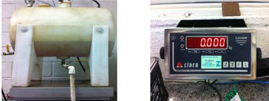
Figura 23 - Balança para medição da massa de óleo diesel e misturas de óleo diesel e etanol
