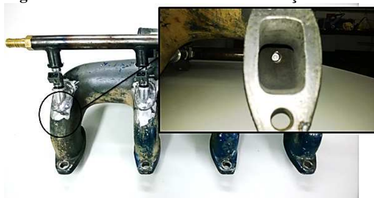
Figura 13 – Detalhe do ramo de distribuição do etanol
