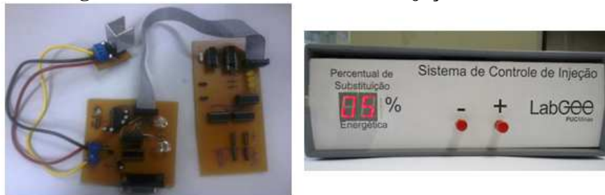
Figura 21 – Sistema de controle da injeção de etanol
