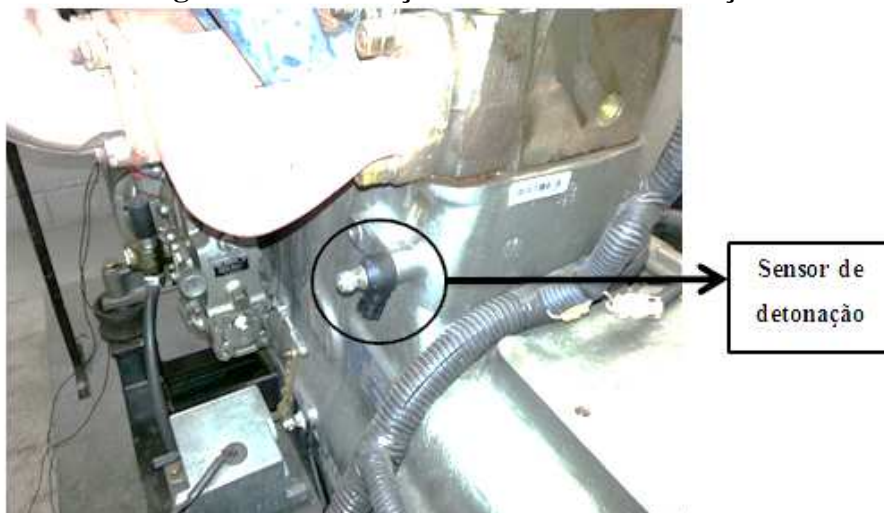
Figura 16 - Instalação do sensor de detonação
