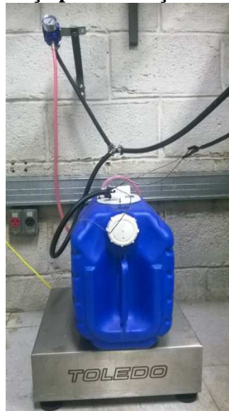
Figura 24 - Balança para medição da massa de etanol
