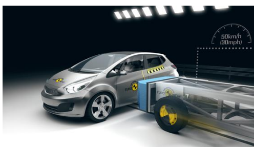
Figura 33 – Configuração de prova conforme normativa ECE 95.
