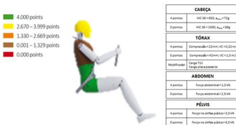
Figura 35 – Distribuição de pontos conforme protocolo de impacto lateral Latin NCAP.
