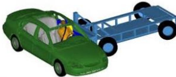
Figura 37 – Modelo virtual para simulação de impacto lateral.
