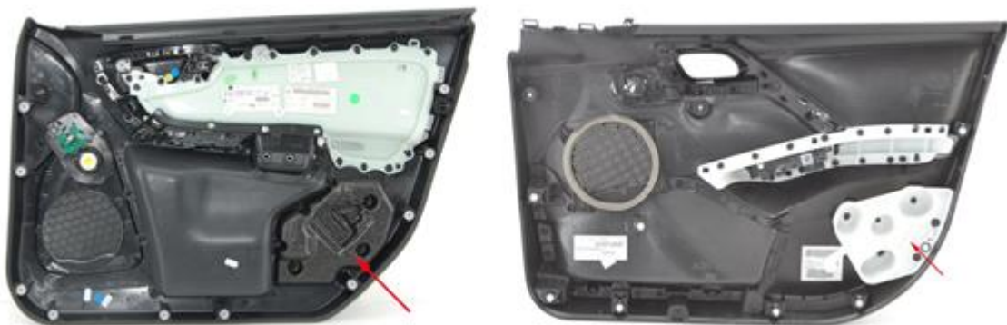
Figura 31 – Absorvedor de energia em polipropileno expandido (a esq.) e em peça plástica (a dir.)
