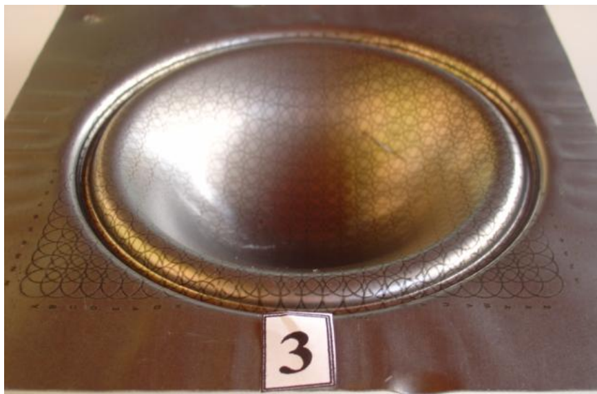
Figura 6 – Aplicação do método visioelasticidade em conformação de chapas
