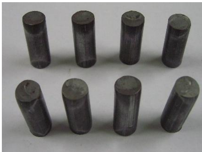
Figura 15 – Corpo de prova cisalhado, evidenciando superfície irregular do corte
