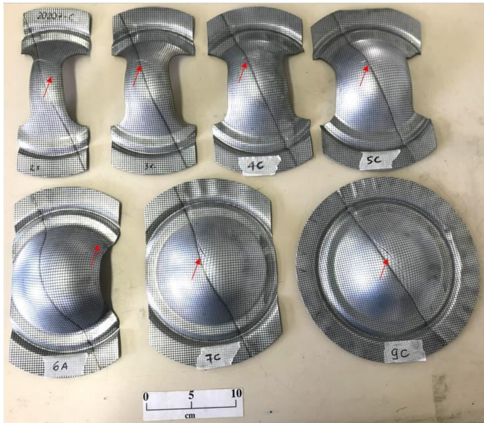
Figura 63 – Amostras extraídas do ensaio de Nakazima com orientação da linha de solda em 52° a direção de laminação da chapa
