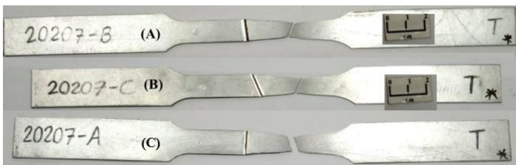
Figura 61- Corpos de prova de tração, extraídos das chapas nas quais foram tiradas as amostras para CLC, com inclinação relativa da linha de solda de (A) 38°, (B) 52° e (C) 0°
