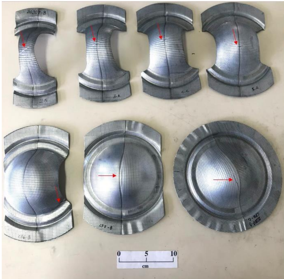
Figura 62- Amostras extraídas do ensaio de Nakazima com orientação da linha de solda em 38° a direção de laminação da chapa
