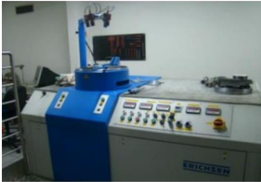
Figura 51 - Equipamento Erichsen utilizado para ensaio Nakazima
