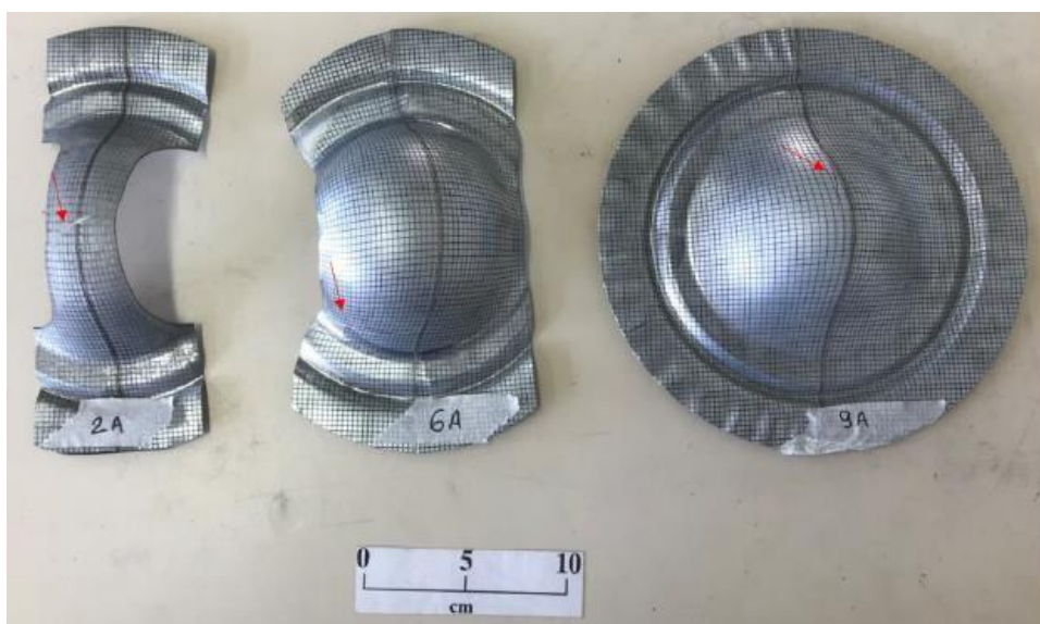
Figura 64– Amostras extraídas do ensaio de Nakazima com orientação da linha de solda em 0° a direção de laminação da chapa
