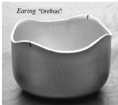
Figura 10 – Formação de “orelhas” após embutimento
