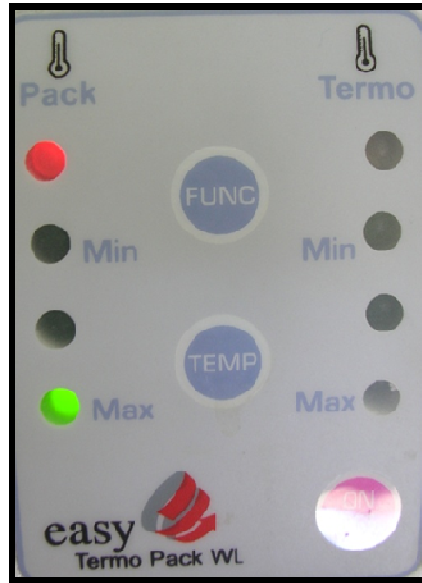
FIGURA 5-Display do Easy Pack WL: aquecendo a guta-percha (Fonte: Arquivo pessoal).
