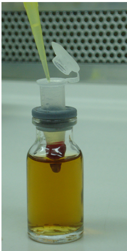
FIG. 1 - Aparato sendo inoculado com a suspensão microbiana.
